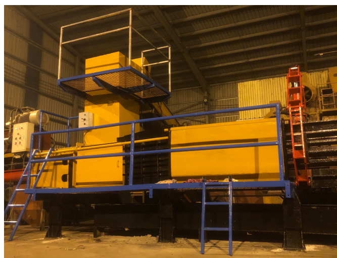
Thiết bị ép tách hữu cơ mô mềm và nước
