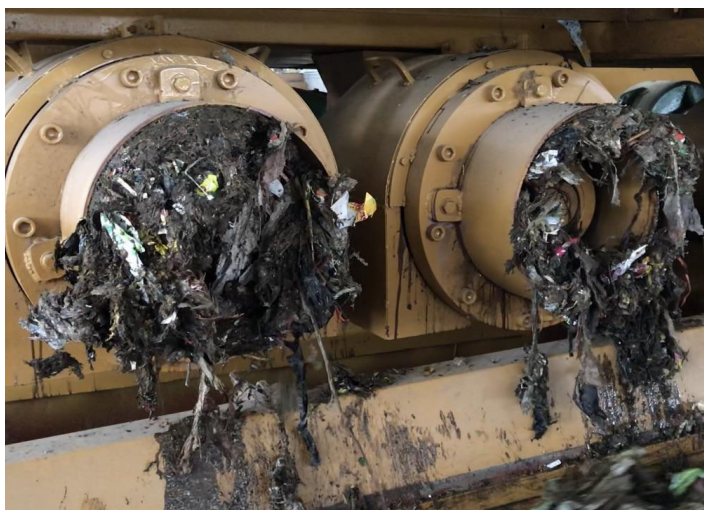
Thiết bị ép tách hữu cơ mô mềm và nước
